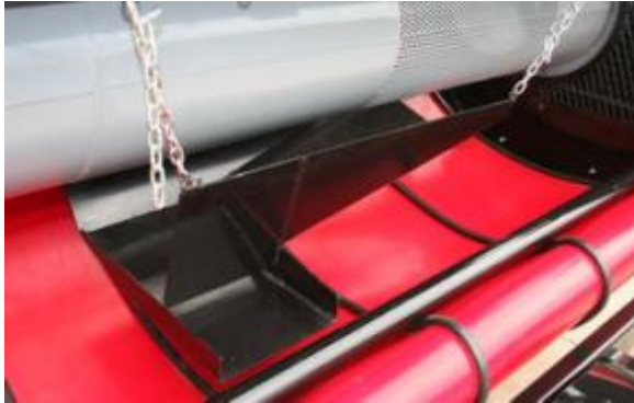
Vista lateral mostrando bandeja de distribución de material que asegura una alimentación óptima al concentrador.
