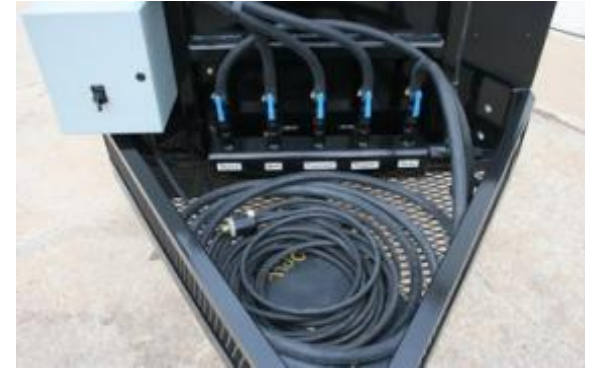
Control distribuidor de agua con mangueras reforzadas de alto rendimiento y cable de suministro eléctrico
