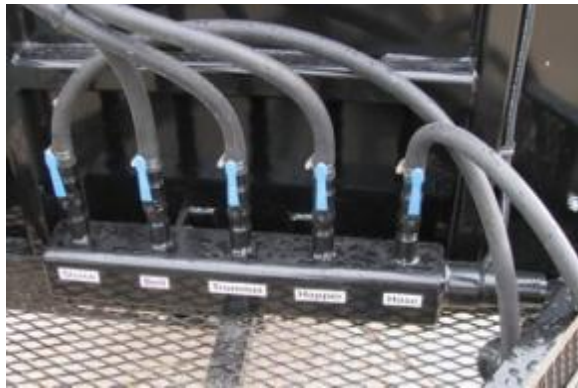
Flujo de agua a cada sección de la máquina es controlable independientemente.
