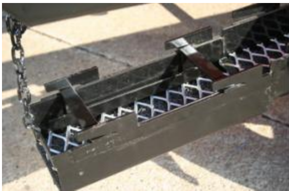
Canal con mallas resistentes a la corrosión, seguros y esteras de doble fibra para retención de partículas densas.
