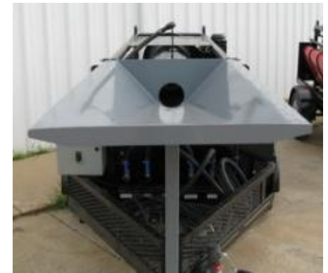
Tolva que permite retención y alimentación de material inferior a 6" (15cm).
