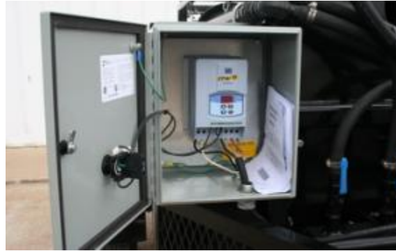
Control de velocidad para el trómel y concentrador montado en caja resistente al agua con interruptor on/off externo
