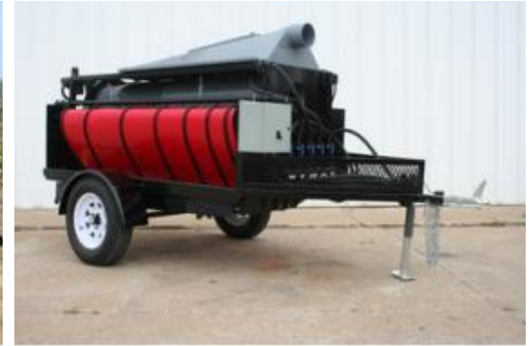
Vista lateral mostrando la caja de control eléctrica, resistente al agua para seguridad y confiabilidad
