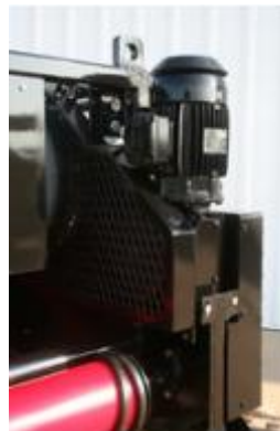
Motor de lavado (1,5 HP) con sistema de engranaje resistente.
